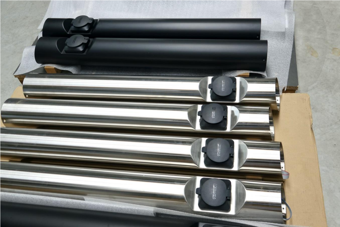
Edelstahl-Ladesäulen mit der über Easy Arc verschweißten Platte und der bereits fertig montierten Elektronik.
